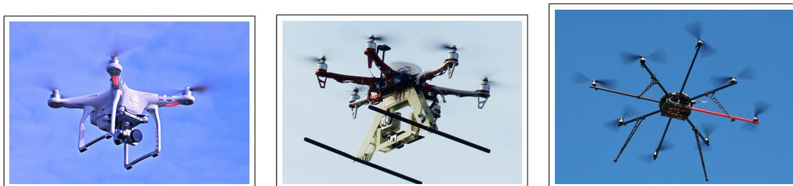
Figura 1.1: Esempi di MAV multirotore con quattro, sei e otto pale rotanti.
